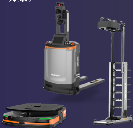
自動導引車 AGV 實現倉儲貨物無人化搬運 優化物流效率與空間利用率
