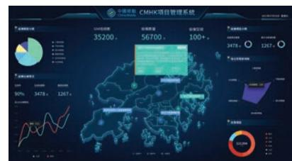
傳感器可設置於不同地方，當有問題時可透過平台通知，工作人員可迅速反應，縮短排查時間。現時CMHK引入溫濕度感應器、紅外線感應器、漏水監測器及門磁警報器，採用NB-IoT制式，體積輕巧，方便安裝。
